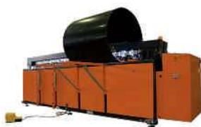
MAQUINAS DE TERMOFUSION PARA PLANCHAS
