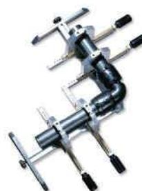
Herramientas mecánicas apropiadas para alinear y sostener los tubos en la soldadura con coplas electrofusión, evitando así esfuerzos que pueden comprometer el resultado de la soldadura.
